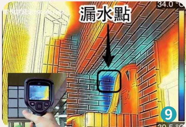
■ 透過紅外線顯像儀檢測是否有漏水處。
